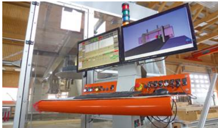
Die offene Maschinensteuerung erlaubt die Einbindung unterschiedlicher CAM-Systeme. Die Programmierung wurde zusammen mit Lignocam realisiert.
