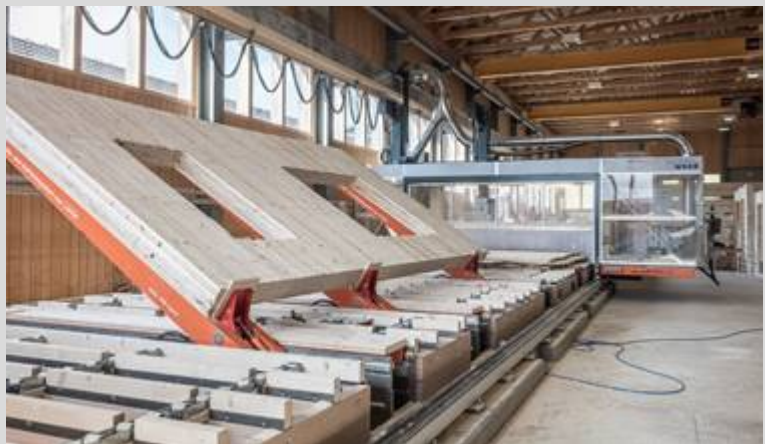
Abb.: Das Wende- und Aufrichtsystem TW-Flip – hier im Einsatz innerhalb der neuen Vollholz-Produktionsstrasse der Nägeli AG in Gais.
