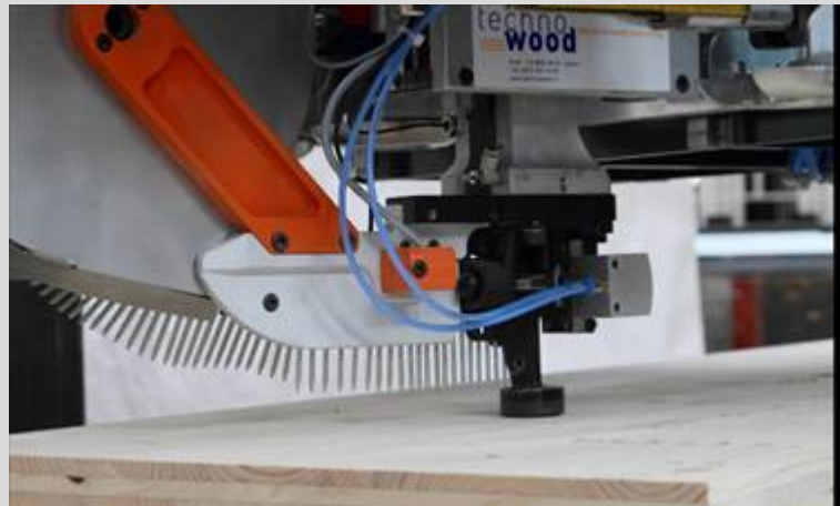
Abb.: E-Modul bietet Platz für bis zu 8 Spezialaggregate (z.B. Nagel-, Klammer und Fräsaggregate)
