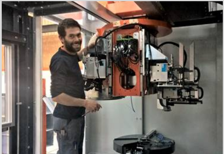
Lukas Bollhalder am «E-Modul» der TW-Mill E – Das 4-Achs-Aggregat nimmt bis zu 8 verschiedene Geräte auf. Eine nie gekannte Bearbeitungsflexibilität im Elementbau wird so erreicht.
