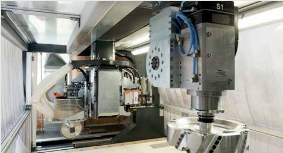
Eine 5-Ach-Spindelaggregat (vorne) und ein zusätzliches 4-Achs-Aggregat (E-Modul) ermöglichen größtmögliche Flexibilität bei der Bearbeitung aller erdenklichen Elemente.
